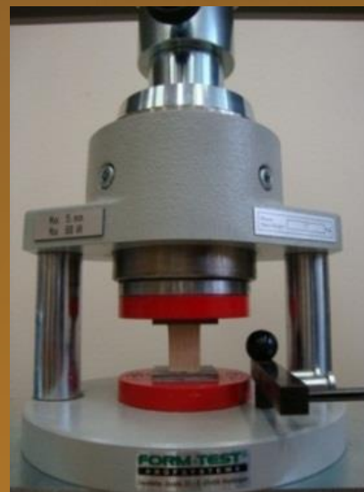
Рисунок – Определение предела прочности древесины при сжатии вдоль волокон
