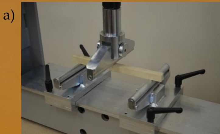
Рисунок – Испытание древесины при статическом изгибе
